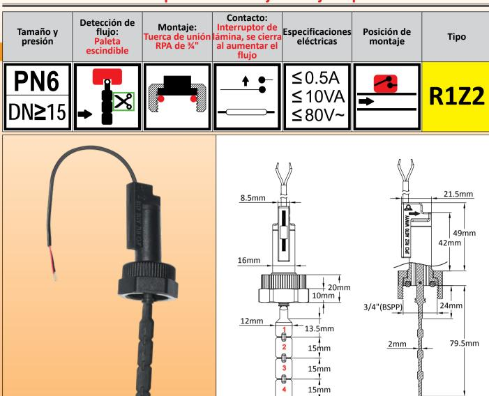
Usos principales: Aplicaciones en grandes cantidades en la detección de flujo en circuitos electrónicos de bajo voltaje. El modelo más económico. La posición de montaje recomendada es en tuberías horizontales. Puede montarse en cualquier posición con una pequeña desviación en la calibración debido al peso de la paleta. Se puede utilizar en tuberías de agua de 15 a 100 mm de diámetro.
